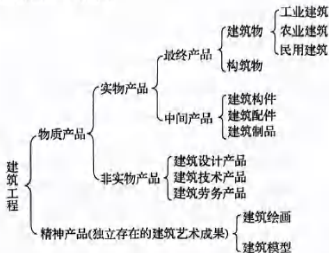
图 0-1 建筑工程的组成
