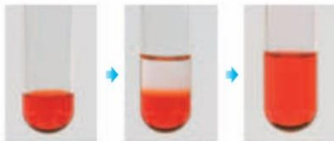
水中滴入红墨水, 振荡 加入乙醇, 不要振荡 振荡, 静置
