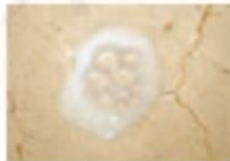
图11-3 盐酸腐蚀含碳酸钙的建材
