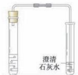
图 11-4 碳酸钠与盐酸反应的装置
