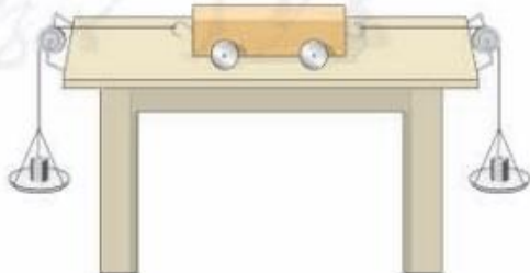
图8.2-2 研究二力平衡条件的一种方法
