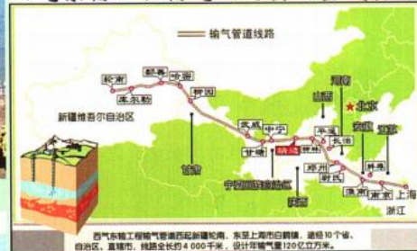
西气东输工程输气管道西起新疆轮南，东至上海市白鹤镇，途经10个省、自治区、直辖市，线路全长约4 000千米，设计年输气量120亿立方米。
