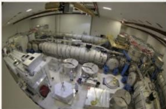
图1.3.3 探测引力波实验装置
