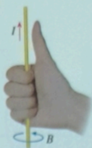
图 13.1-7 直线电流的安培定则
