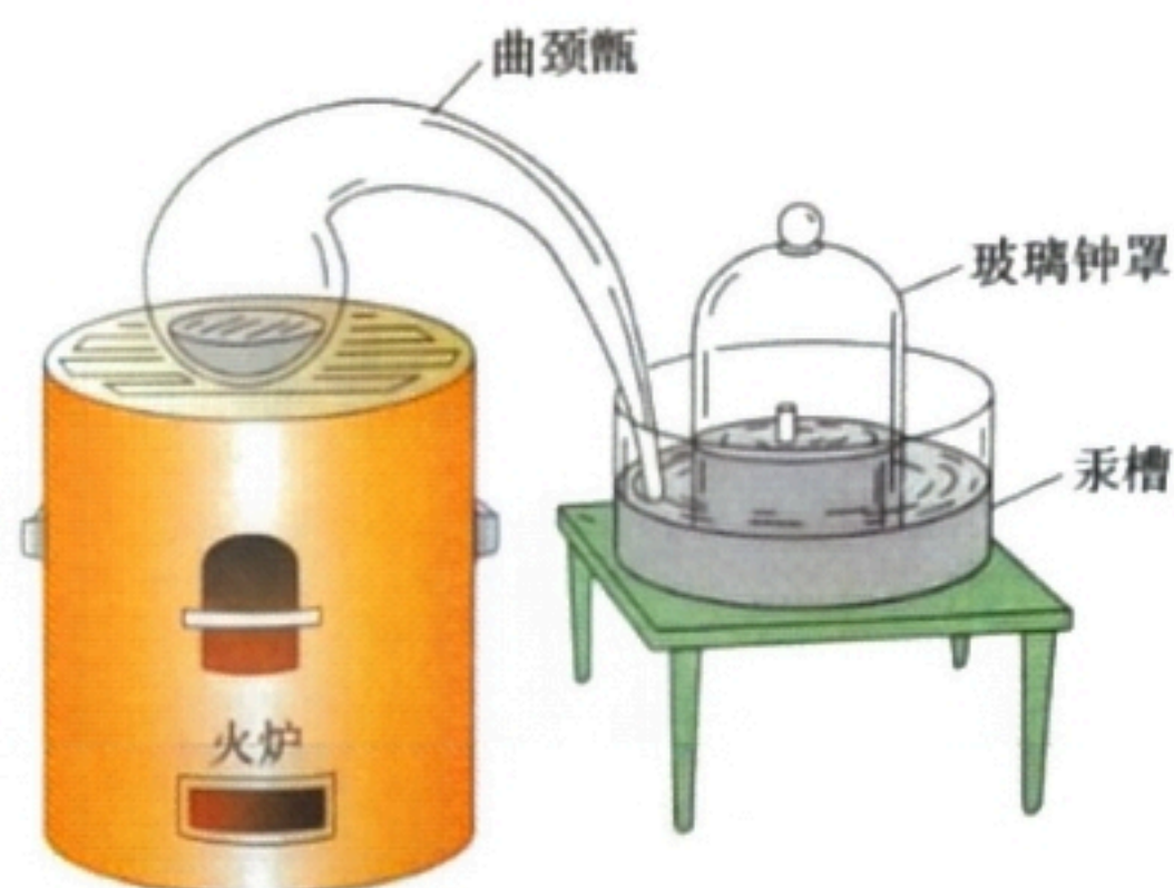
图2-2 拉瓦锡研究空气成分所用的装置
