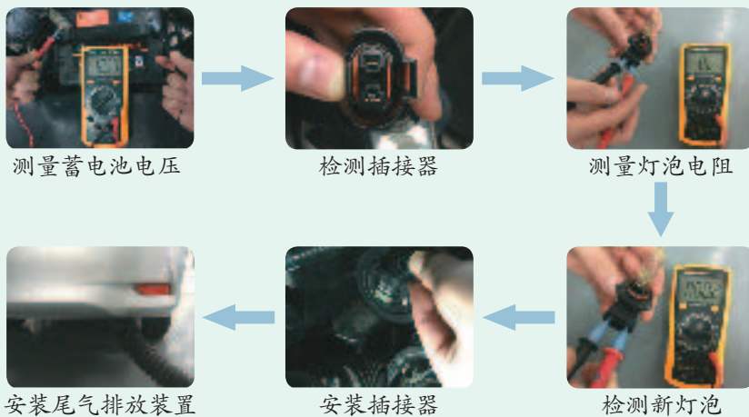
图4-22 排除故障的基本过程
