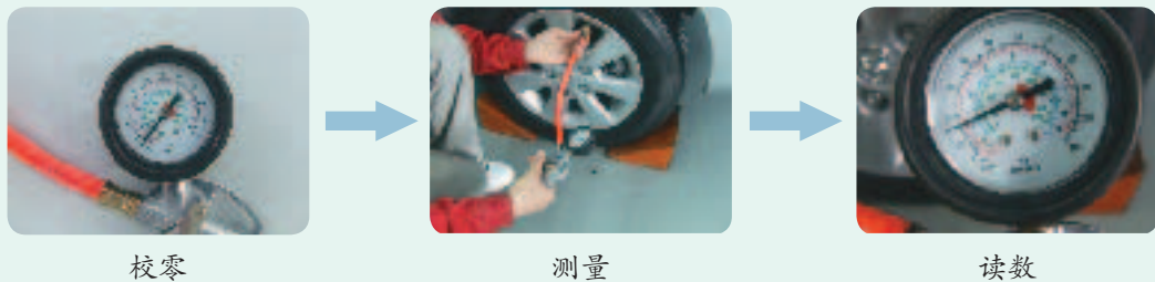
图4-15 用胎压表测量胎压
