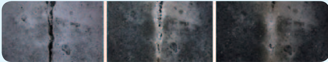
图1-8 能自我修复的混凝土的愈合过程
