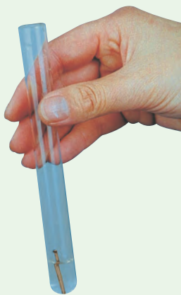
图1-20 盐酸与铁锈的反应
