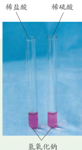
图1-25 氢氧化钠溶液与酸的反应
