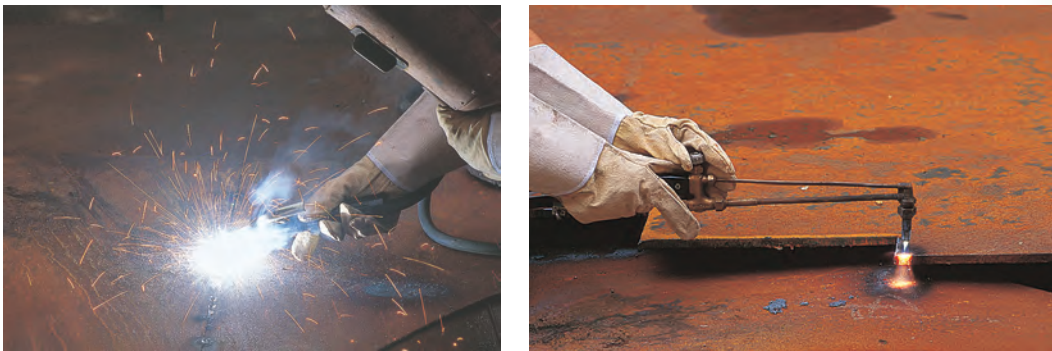
图2-21 用氧炔焰焊接和切割金属
