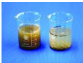
图 5.9 加入凝聚剂前后的泥浆水
