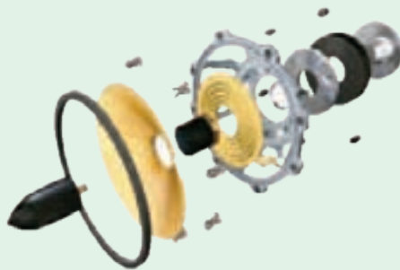
图2-16 某产品的装配示意图
