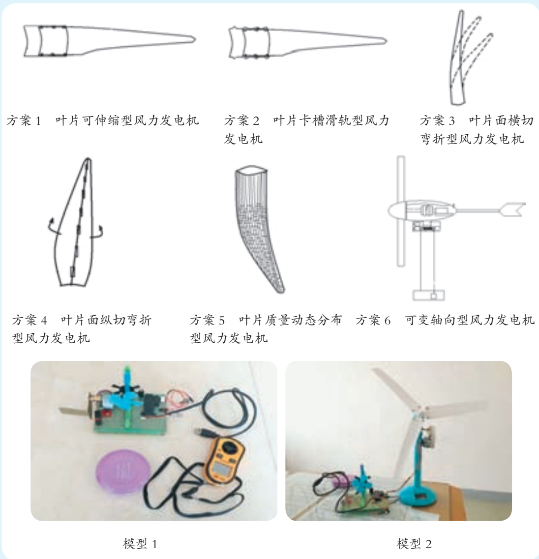
图 4-4 “可变轴向型自适应风速变化风力发电机” 方案设计与模型展示
