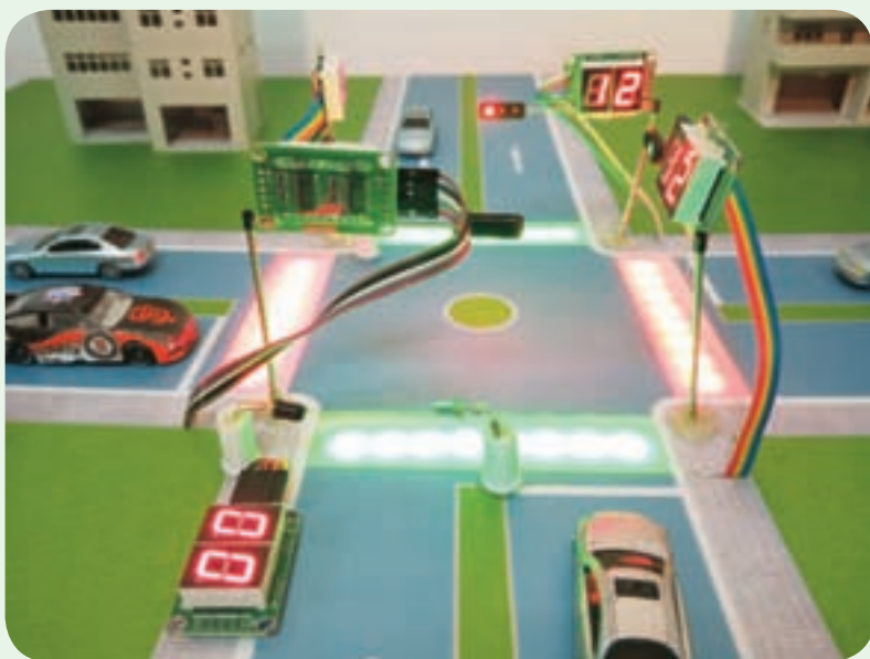
图 3-9 交通路口安全高效信号灯装置模型演示效果
