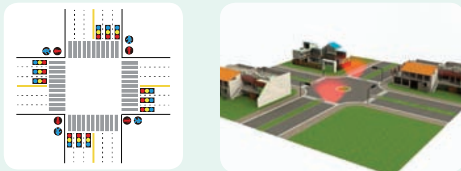
图 3-2 交通路口安全高效信号灯装置示意图和效果图
