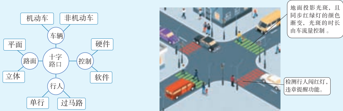
图 3-1 交通路口安全高效信号灯装置示意图和效果图
