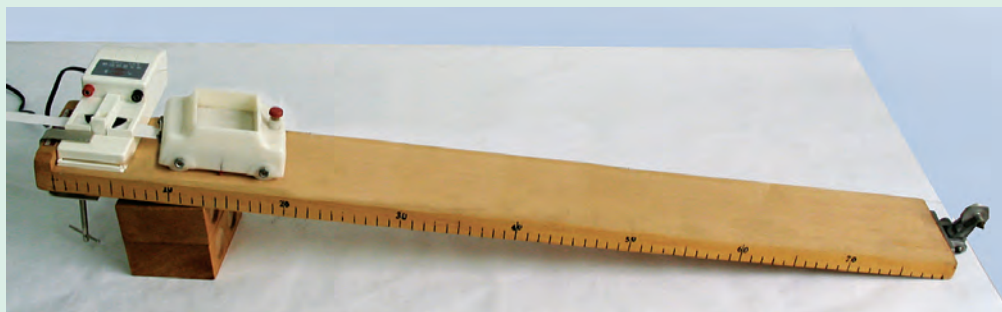
图 1-4-4 用打点计时器记录小车的运动信息
