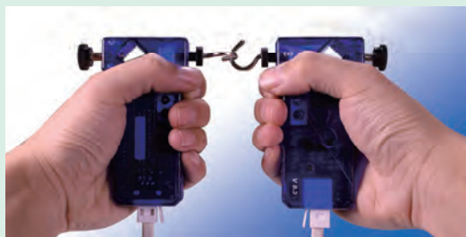
图 4-4-6 用力传感器显示作用力与反作用力
