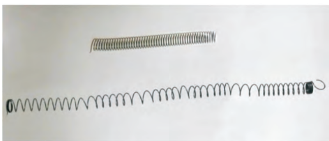
图 3-2-3 形变超过弹性限度的弹簧不能恢复原状所示。
