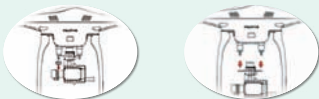
图 4-37 拆卸无人机相机云台
