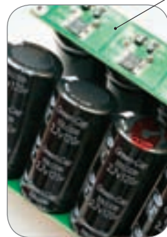
图 3-11 过压保护及电压均衡电路
