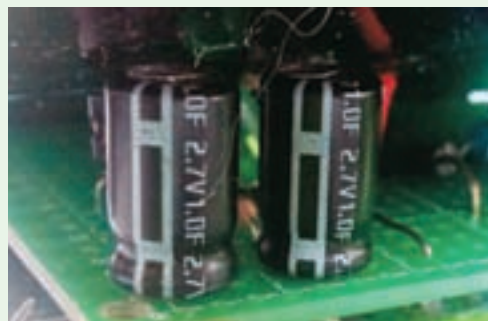
图 3-15 安装、焊接法拉电容器
