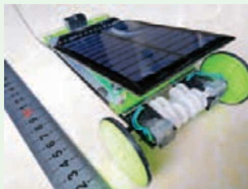
图 3-16 遥控太阳能电动小车结构设计参考
