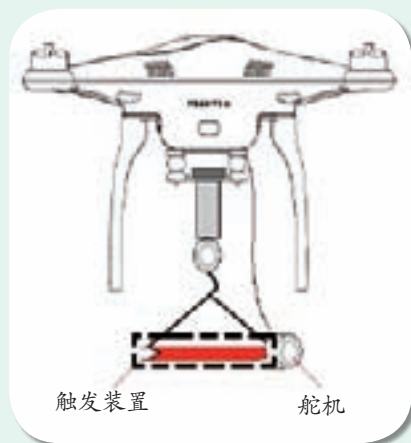
图 4-45 无人机安装触发装置
