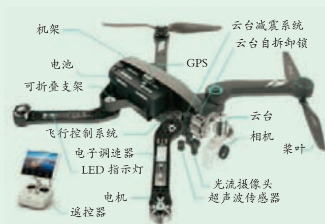
图 4-21 多旋翼飞行器结构
