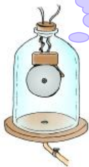
图 1.3 真空铃实验装置
