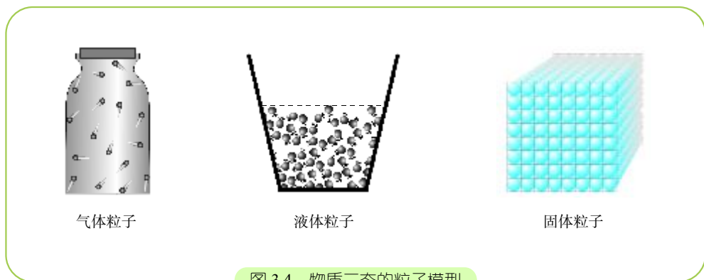
图 3.4 物质三态的粒子模型
