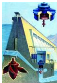
图 2.1 堤坝式水电站示意图
