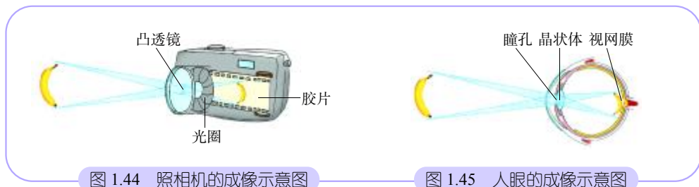
图 1.44 照相机的成像示意图
