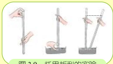
图 3.9 托里拆利的实验
