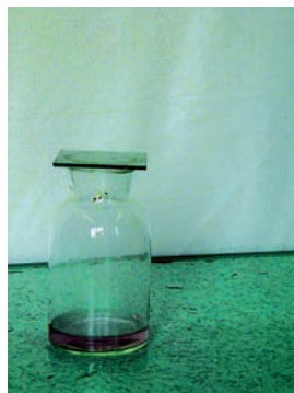
图3.1.5 硫粉燃烧后,向集气瓶倒入少量水,加入石蕊试液测定溶液的酸碱性
