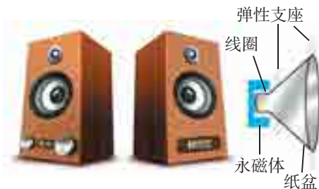
图8-3-7 扬声器结构图
