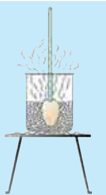
图3-3-2 生石灰与水的化学反应放出大量的热量
