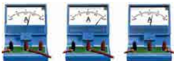
0.32 A 0.56 A 1.4 A 图7-2-5 电流表读数
