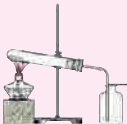
图3-2-2 加热高锰酸钾制取和收集氧气的装置
