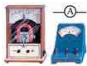
图7-2-4 实验室常用 电流表及其电路符号
