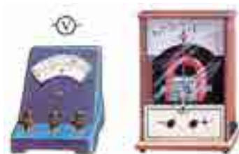
图7-3-2 常见电压表及其电路符号
