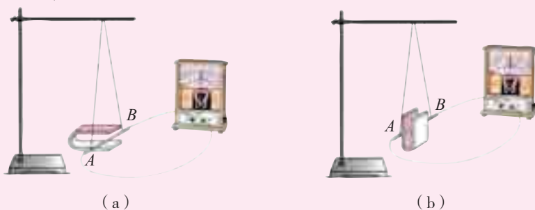
图8-4-1 磁生电实验示意图
