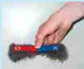
图8-1-2 磁铁吸引铁屑
