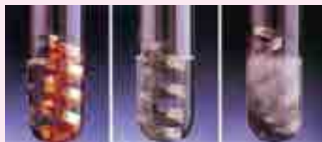
图1-3-1 铜、铁、锌与酸的反应
