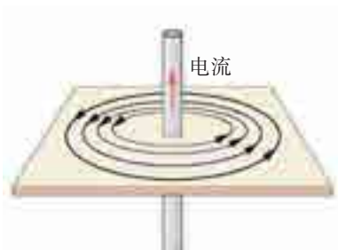
图8-2-3 通电直导线的磁场
