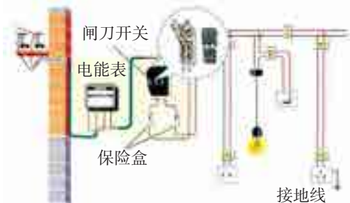
图7-8-2 家庭电路的构成
