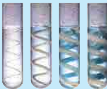
图1-3-2 铜与硝酸银溶液的反应
