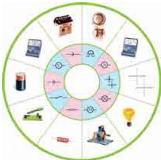
图7-1-5 常见电路元件或电路器件的符号
