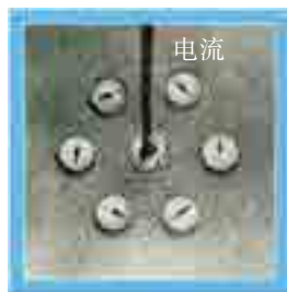
图8-2-4 用铁屑和磁针演示通电直导线的磁场
