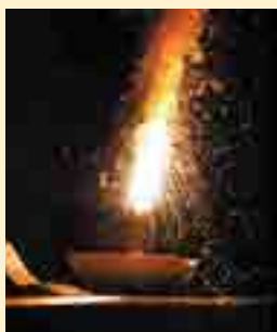
图3-3-4 金属铝与氧化铁的反应
