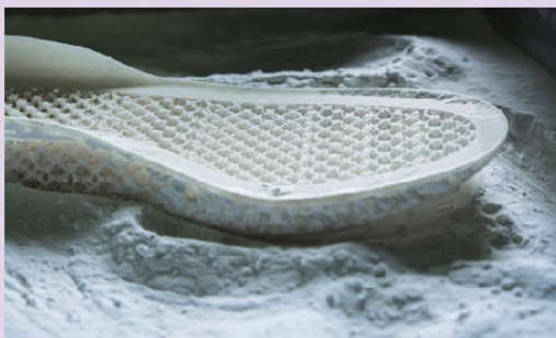
图1-7 2015年三维打印的运动鞋中底
