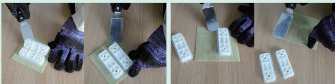
图1-33 使用铲刀撬松并移出模型
