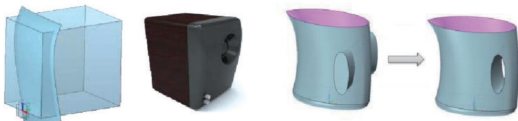
图3-2 混合建模允许用实体修剪曲面形状
