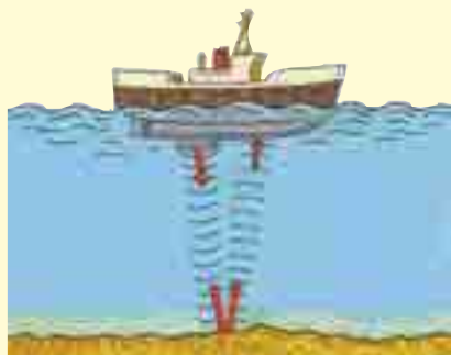
(b) 使用声呐进行海底勘测
