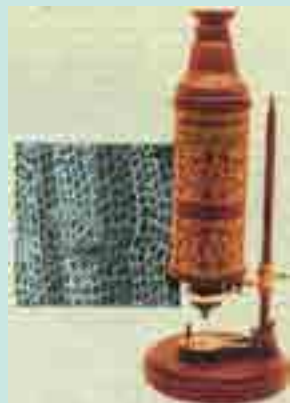
图3-2-6 胡克研制的显微镜和他看到的“细胞”
