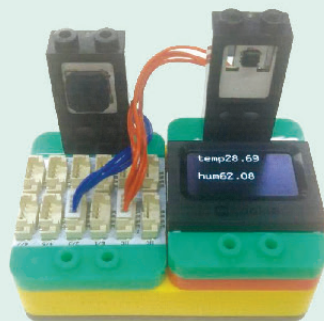
图3-10 OLED显示屏调试结果显示
