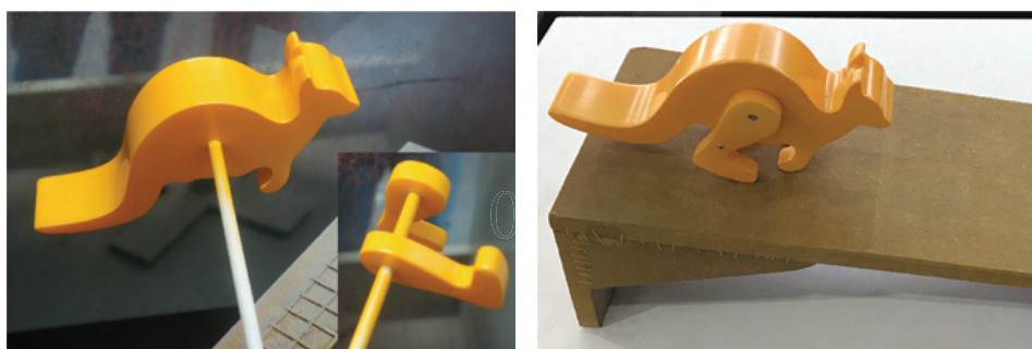
d. 表面喷漆, 干燥后用不同坡度的斜面测试运动性能
