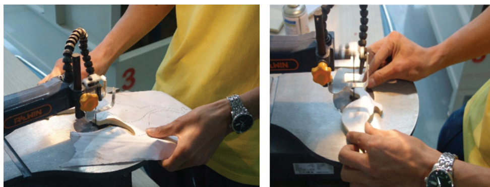
a. 沿图样的轮廓线用曲线锯切割袋鼠外形
