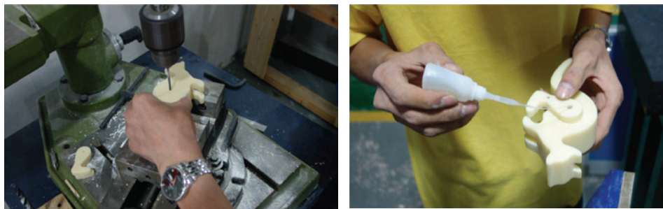
c. 在钻床上钻孔后安装腿并固定钢轴
