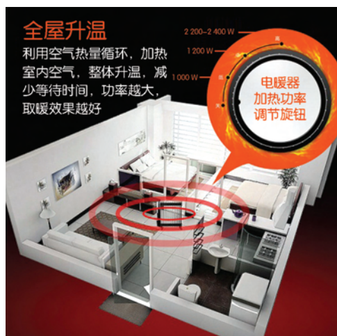
图 4.13 电暖器取暖示意图
