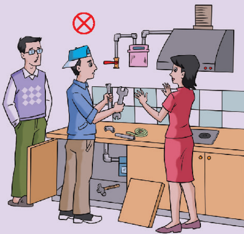
图4-26 严禁私改燃气管道
