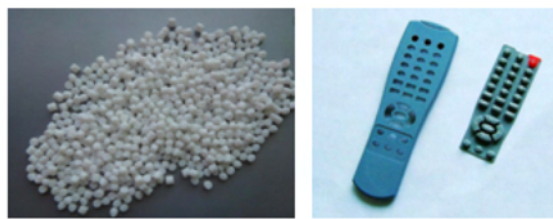
a. 导电塑料颗粒 b. 导电橡胶 图1.27 复合型高分子导电材料的应用
