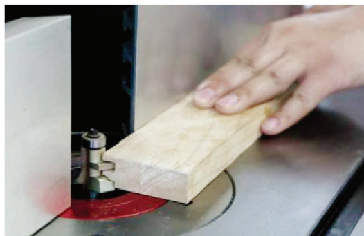
图1-18 铣削木材来开槽
