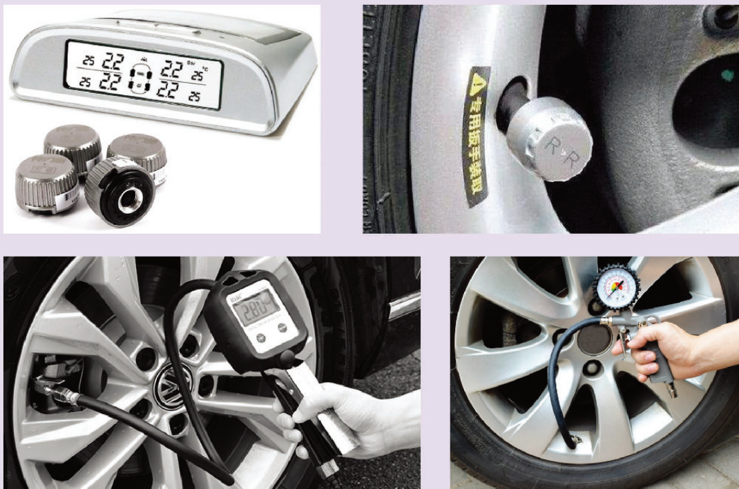
图4-14 用胎压监测系统与胎压表检测胎压
