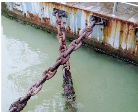
图1-12 铁质材料在海水中容易被腐蚀生锈
