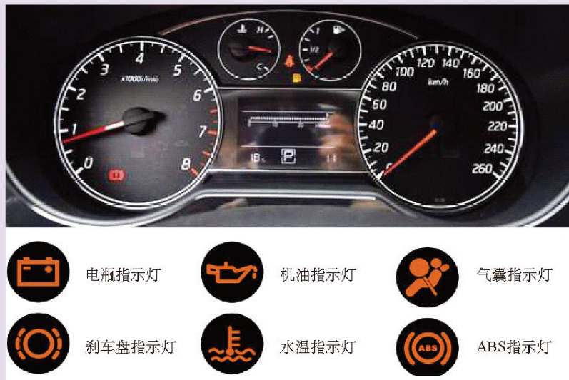
图4-12 汽车仪表盘及常见故障指示灯
