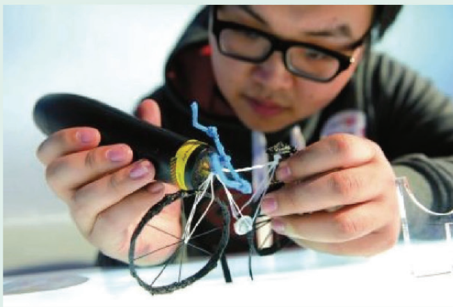
图1-31 用三维打印笔在物体上画实物
