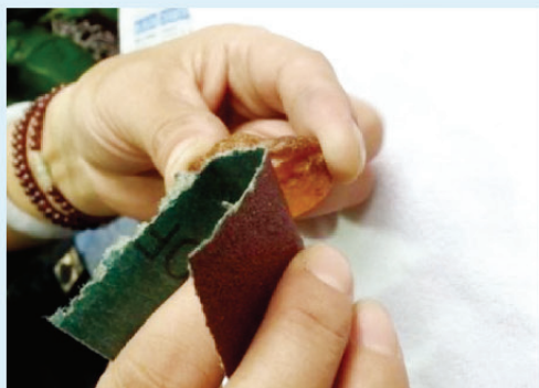
图1-15 用180目砂纸进行粗磨
