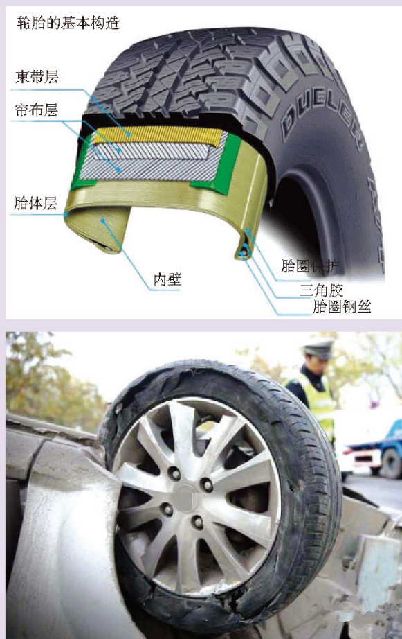
图4-13 轮胎结构及爆胎引发的事故
