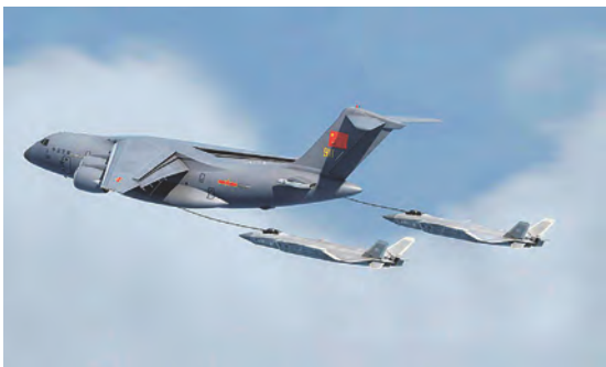
图3-3 飞机在空中加油时要求受油机和加油机保持相对静止
