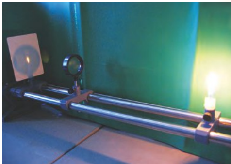
图2-67 凸透镜成像探究
