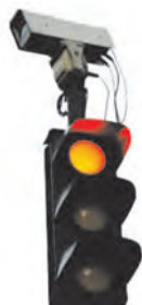
图3-12 街头电子测速仪能自动测出并记录过往车辆的速度
