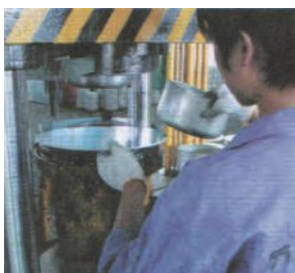
图3-22 压力将铝板压成锅
