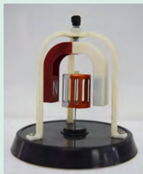
图 2-5-4 探究磁场中涡流的机械效应实验装置
