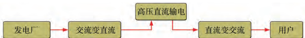
图 3-4-5 现代直流输电示意图
