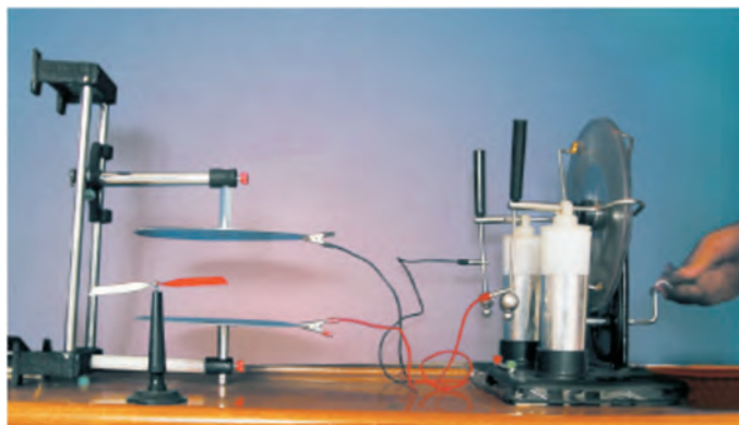
图 4-2-3 电容器充电时，其附近的小磁针发生摆动
