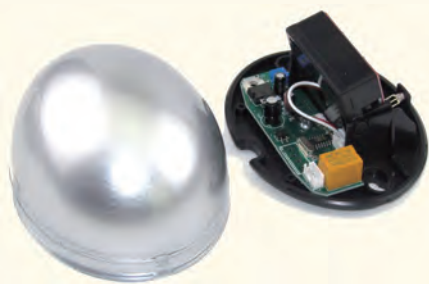
图 5-2-3 自动门上的红外线传感器
