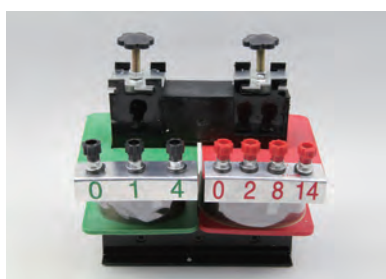
图 3-3-3 实验室用的可拆变压器
