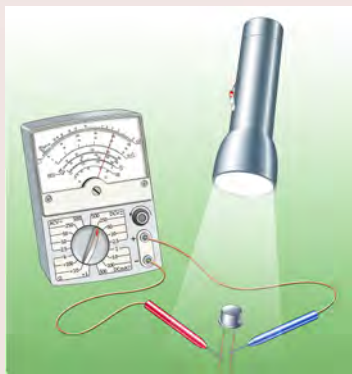
图 5-1-13 用多用电表测光敏电阻阻值的变化
