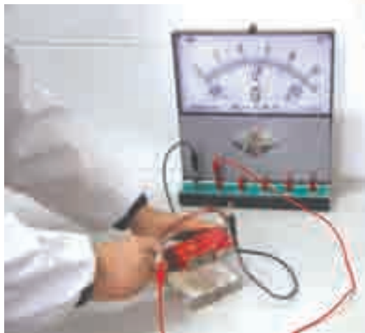
图1-47 磁场中运动的导体
