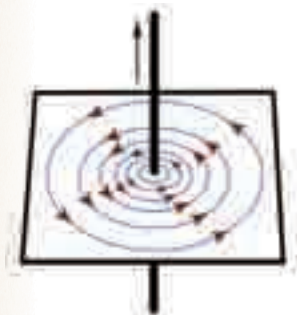
图1-22 通电直导线周围的磁感线分布
