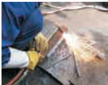
图3-6 乙炔在氧气中燃烧产生的高温火焰可用来切割或焊接金属
