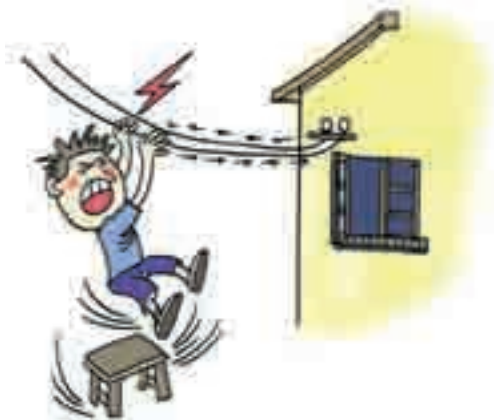
图1-70 人同时接触两根电线时触电
