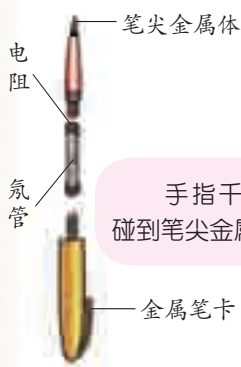
图1-58 测电笔的结构
