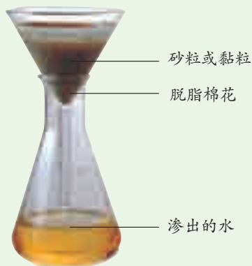
图4-12 土壤的渗水实验
