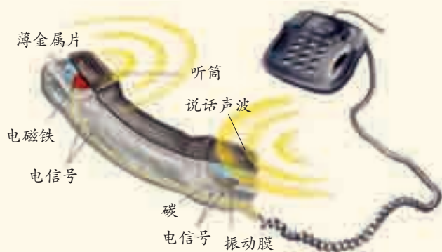
图1-38 电话机的原理
