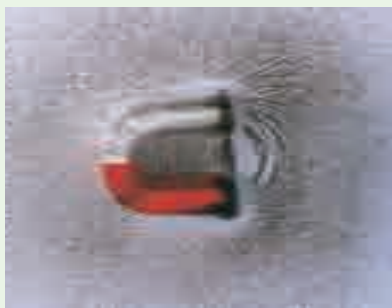
图1-11 蹄形磁铁的磁场
