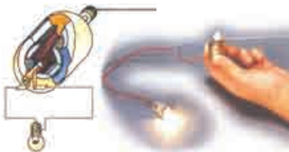
图1-53 旋转电动机的磁体就可以产生电
