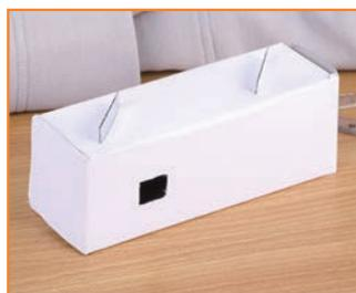
在潜望镜的窥测口，你能看到经过两次反射后的物体吗？
