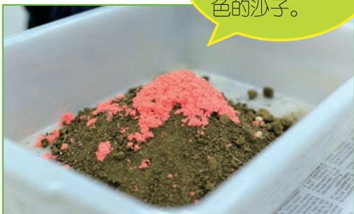
(2) 用喷壶中的水喷洒小山丘的顶部，观察“雨水”对小山丘的影响。
