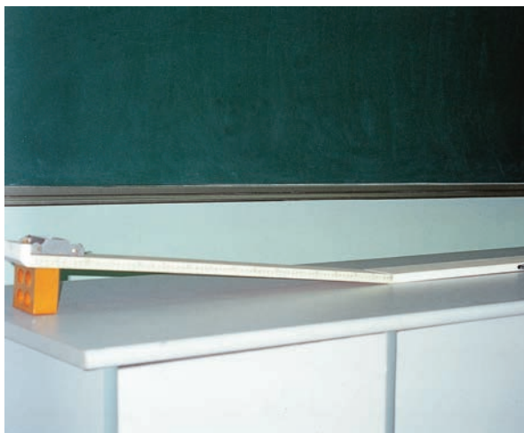
图1.4.1 从斜面滑下的小车的运动
