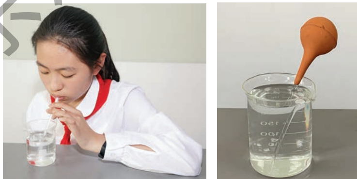
图5.2.8 检测吸入气与呼出气中二氧化碳含量差异的实验装置及操作示意图
