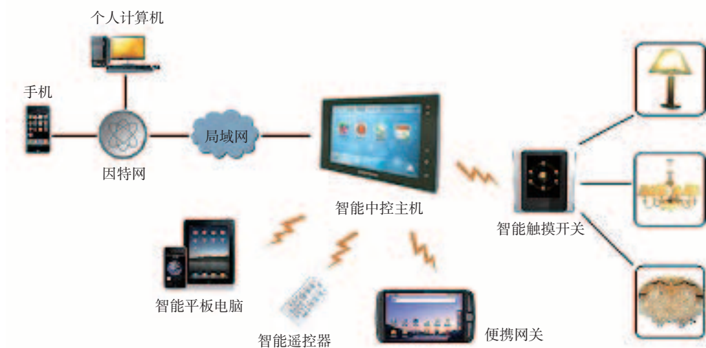
图2-31 智能家居照明系统控制方案
