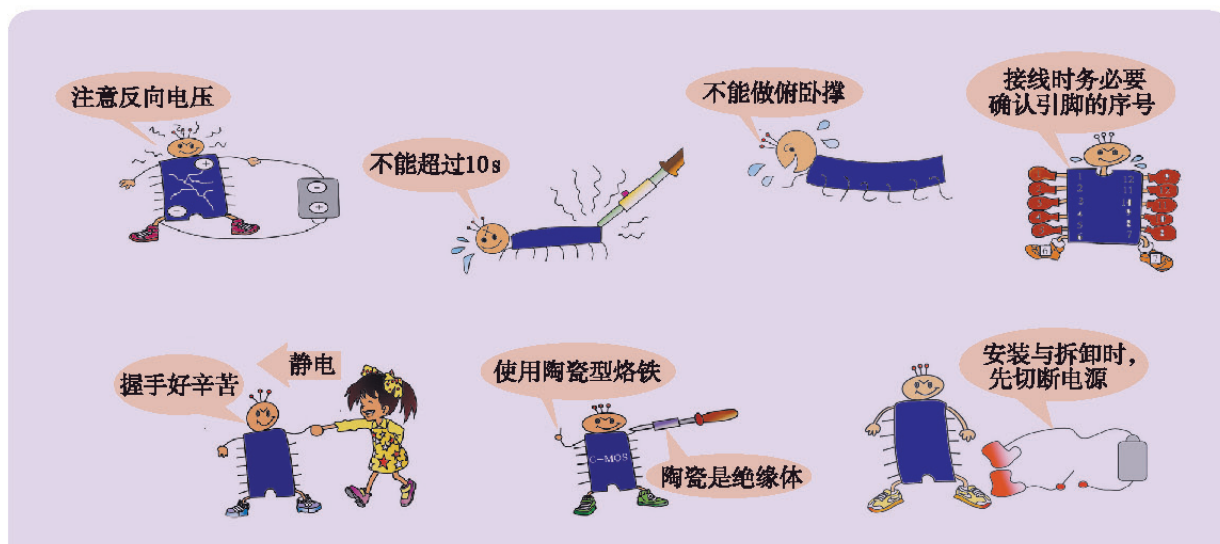
图3-42 数字集成电路的使用注意事项示意图
