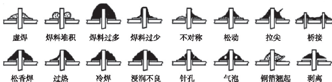
图2-40 焊接缺陷示意图
