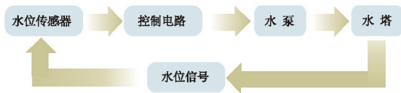
图 5-17 水塔水位自动控制电路系统框图
