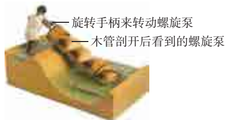
(c) 阿基米得螺旋泵
