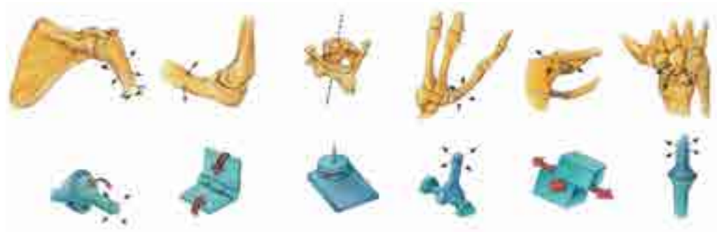
图3-1-10 关节与一些简单机械部件的对比
