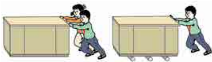
图1-3-12 滑动摩擦与滚动摩擦
