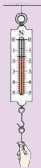
图1-2-2 被拉下秤钩的弹簧测力计
