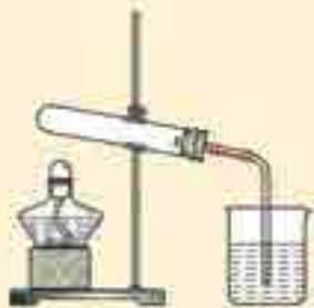
图3-2-3 检验实验装置气密性示意图
