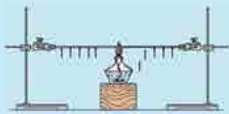
图1-3-3 比较玻璃与铁的导热本领
