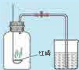
图3-1-4 红磷燃烧实验装置示意图
