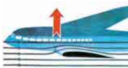
图3-4-3 机翼升力产生示意图
