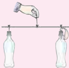
图3-5-9 验证空气浮力实验示意图
