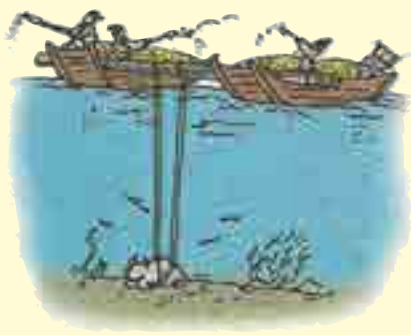
图3-5-7 双驳抬撬法打捞铁牛
