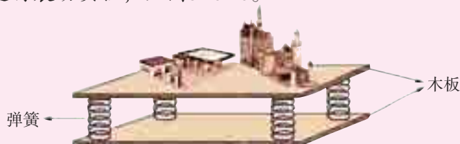
图5-3-8 简易地震实验台
