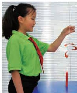
剪一个蛇形纸带，用细线悬挂在蜡烛火焰上方，记录观察到的现象。
