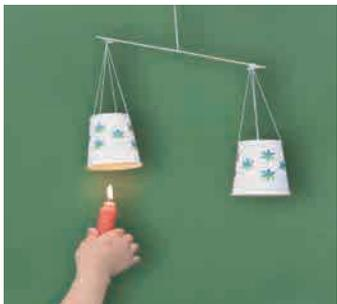
将两个相同纸杯挂在简易天平两端，调节平衡，烤热一个纸杯内的空气，记录观察到的现象。
