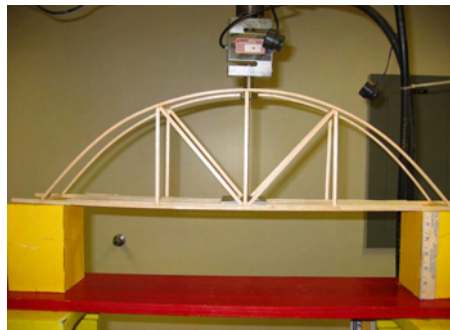
图 3.87 桥梁模型的承重试验
