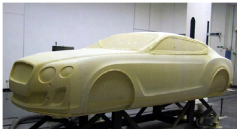
图 3.43 用泡沫塑料和油泥制作的全尺寸汽车车身模型
