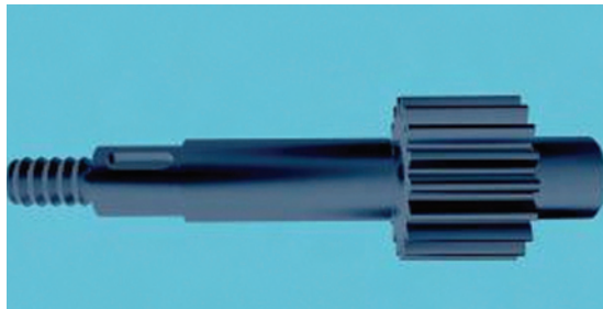
图 2.5 齿轮轴的三维设计图
