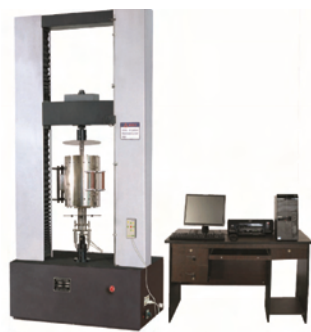
图 4.13 KC-DC300A 型电子万能试验机
