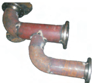
图 3.82 金属管道焊接
