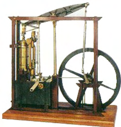
图 1.6 瓦特改良的蒸汽机
