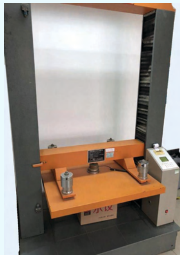
图 4.16 用压力试验机测试包装件的抗压强度
