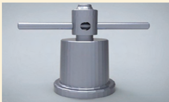
图 3.39 千斤顶虚拟装配样品
