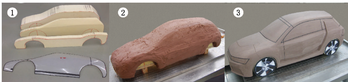
图6-9 较大油泥模型的制作方式
