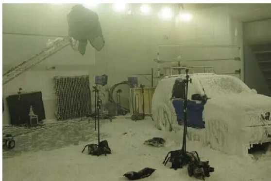
图7-2 汽车环境风洞降雪模拟试验
