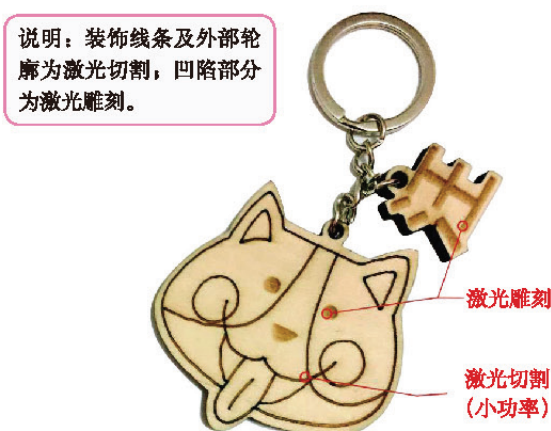
图6-34 用激光雕刻切割机加工的钥匙链挂饰
