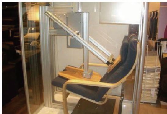
图7-3 椅子疲劳耐久性试验
