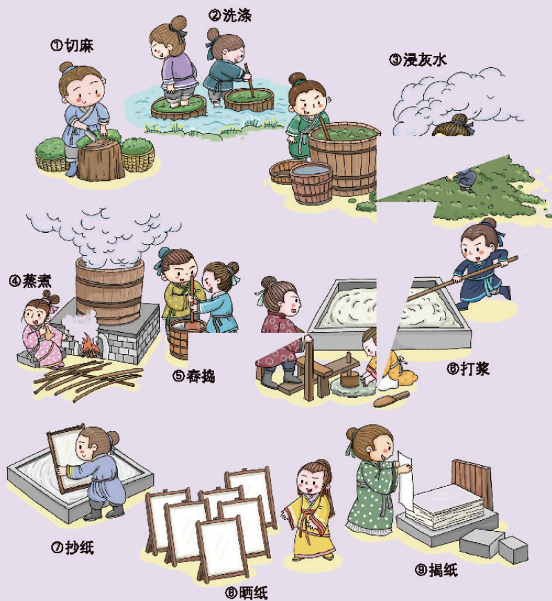
图1-7 古代造纸流程
