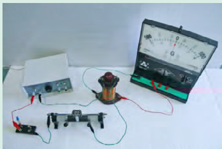
图 6-3-4 利用通电螺线管的探究实验
