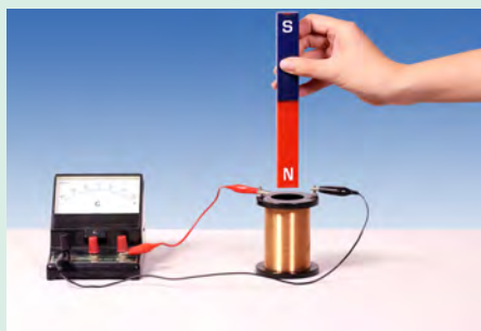
图 6-3-3 利用条形磁铁的探究实验
