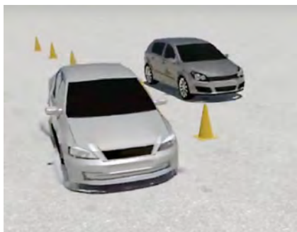
图 6-3-5 没有安装 ABS 的汽车（左）与安装了 ABS 的汽车（右）的模拟刹车情况
