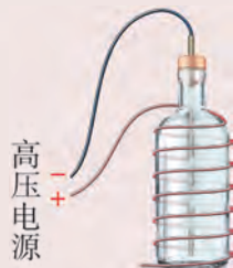
图 2-3-2 静电除尘装置图
