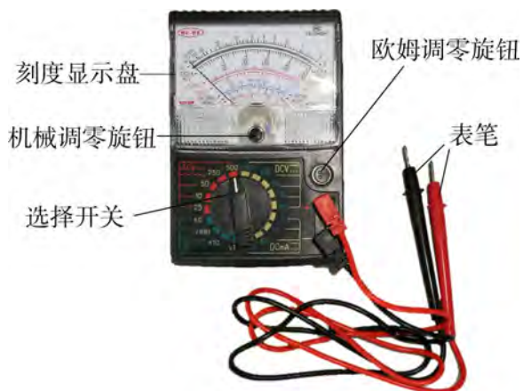
图 4-4-1 指针式多用电表
