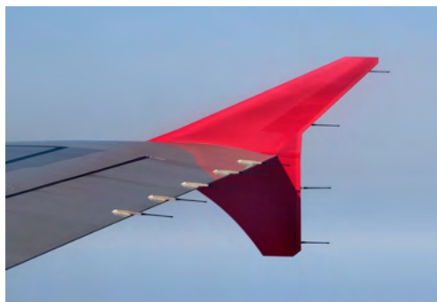
图 2-3-8 飞机上的“放电刷”
