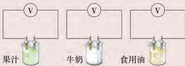
图 4-2-1 用不同电解液制成的原电池
