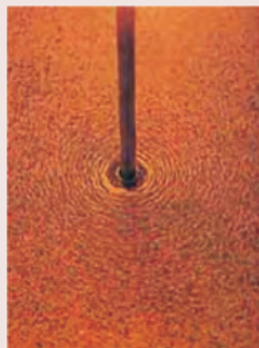
图 6-1-9 直线电流周围 磁场中铁屑的分布情况图
