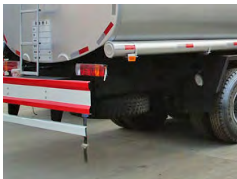
图 2-3-9 油罐车尾的铁链
