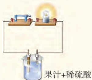
图 4-2-4 加了稀硫酸的果汁电池实验
