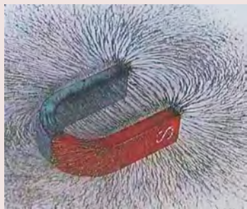
图 6-1-7 蹄形磁铁磁场中铁屑的分布情况图
