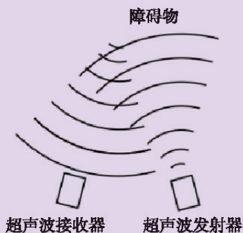
图3-22 超声测距传感器工作示意图
