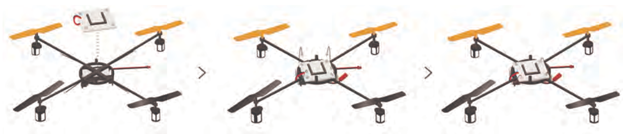
图 3.54 主控系统模块安装示意
