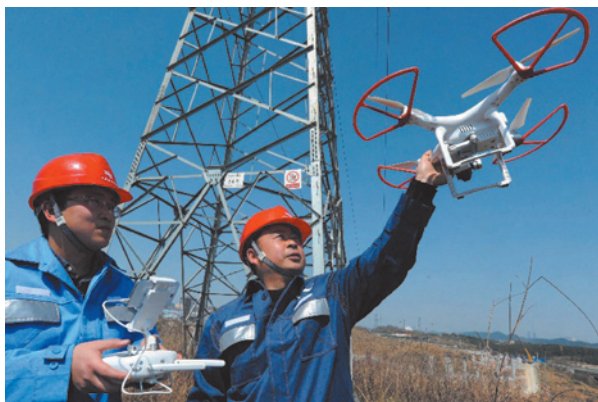
图 3.4 使用无人机进行电力巡线
