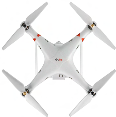
图 3.33 四旋翼飞行器“X”形结构
