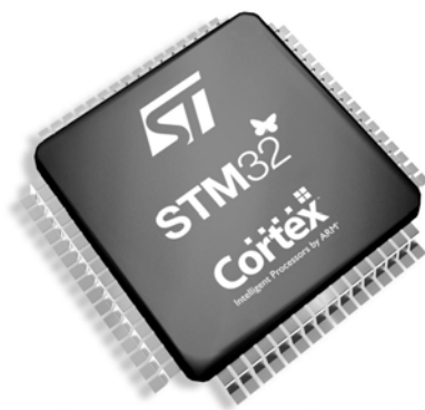
图 3.48 STM32 系列 M3 核微控制器
