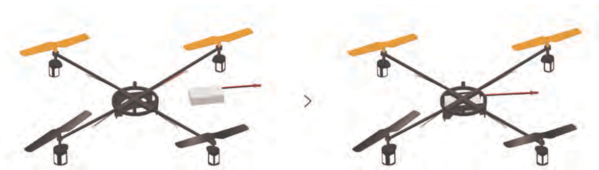
图 3.53 电池安装示意
