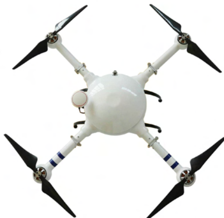
图 3.34 四旋翼飞行器“十”字形结构
