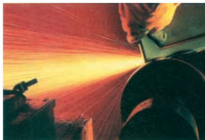
图 3-1-4 火花沿砂轮的切线方向飞出
