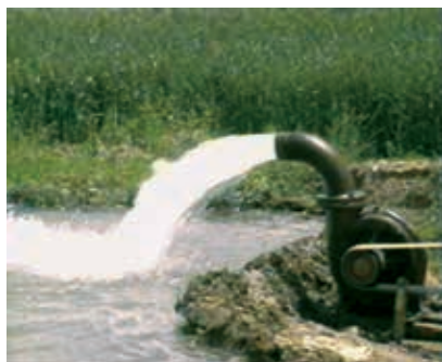
图 3-4-5 正在抽水的离心式水泵
