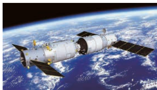
图4-3-11 在科技人员的精确控制下，“天舟”一号货运飞船经多次变轨，于2017年4月22日10时02分转入自主控制状态，以自主导引控制方式向“天宫”二号空间实验室逐步靠近
