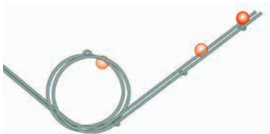
图 3-3-2 观察沿斜面轨道滚下的小球通过圆周轨道的情况
