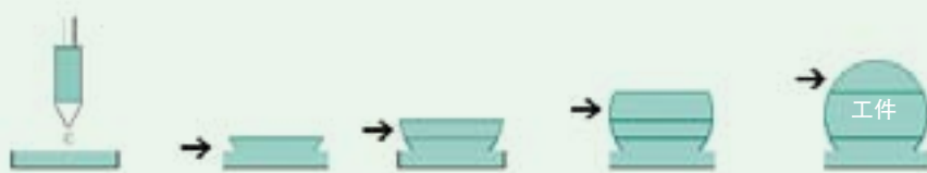
图 1-4 增材制造加工过程示意图
