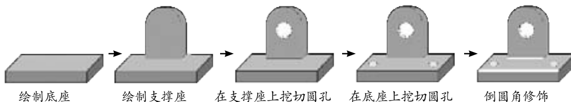
图 3-8 三维模型绘制过程
