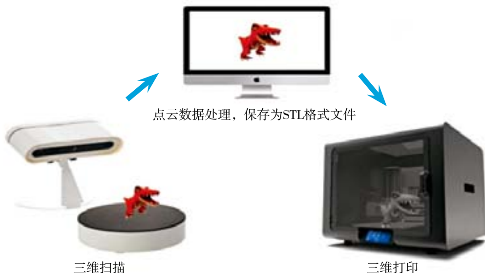
图 3-3 使用三维扫描获取三维数字模型的一般过程
