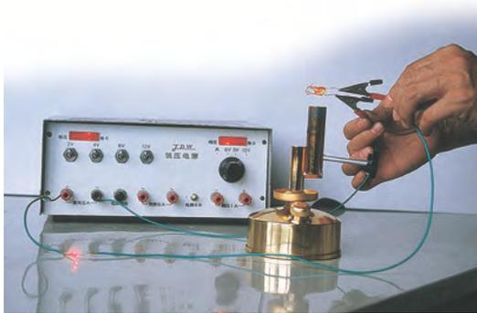
图4-30 烧红的玻璃能导电
