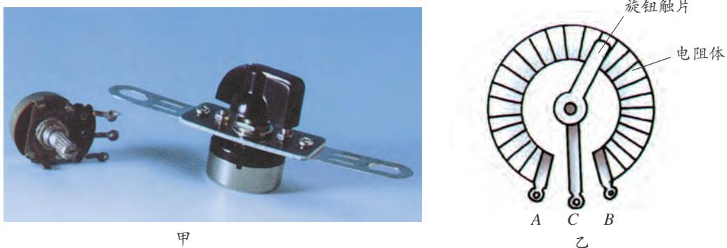
图4-40 旋钮型变阻器
