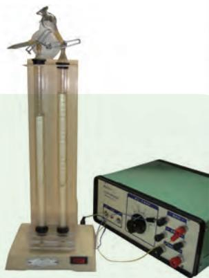
图1-10 电解水的装置
