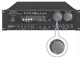
家庭音响的功放机通过改变流过扬声器的电流大小来控制音量。
