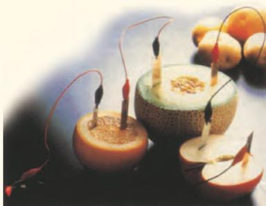
图4-47 水果电池使二极管发光
