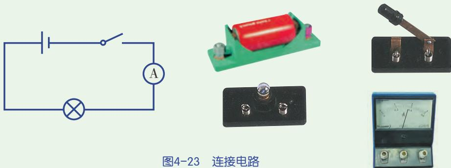
图4-23 连接电路
