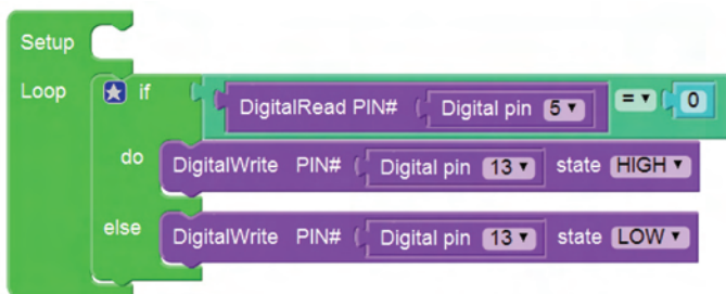
图 2.46 按键控制 LED 的完整图形化程序
