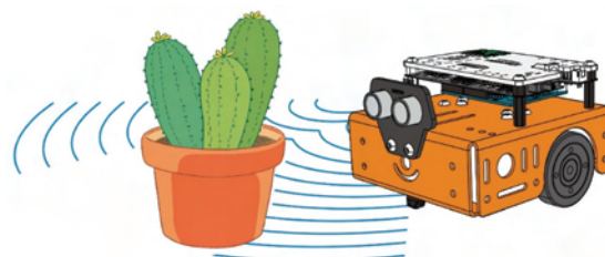
图 3.20 机器人避障示意图
