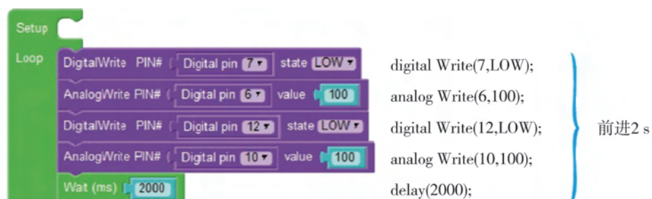
图 2.55 机器人前进 2 s 的图形化程序与代码程序的关系
