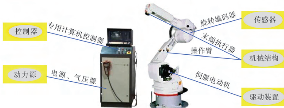
图 1.11 机器人系统的组成
