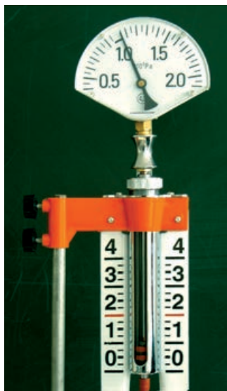
图 2-3-1 探究等容过程的实验装置
