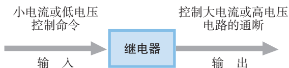
图 4-10 继电器工作方框图
