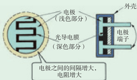
图 2-8 光敏电阻结构图
