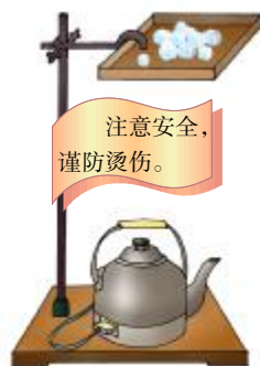
图 3.6 模拟大气降水实验装置
