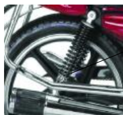
图 2.15 摩托车减震器
