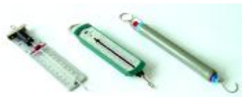
图 2.49 实验室常用的弹簧测力计
