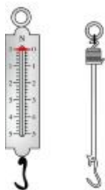
图 2.50 弹簧测力计的外观和内部构造
