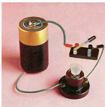
图 4.3.1 电池、小灯泡、开关实验电路
