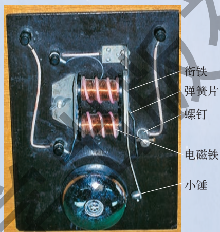
图5.2.9 电铃结构图
