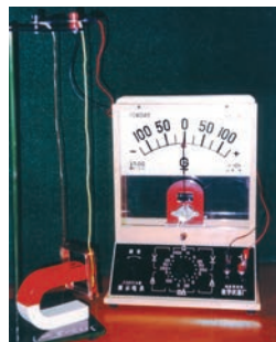
图5.3.3 感应电流的产生
