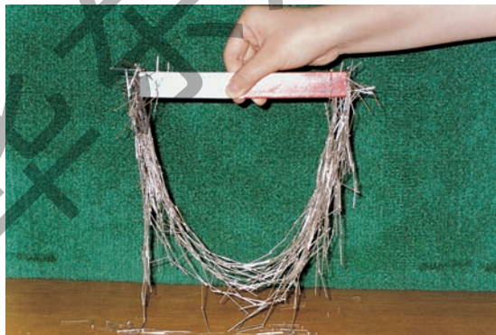
图 5.1.1 磁极处的磁性最强
