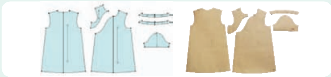
图4-6 旗袍校服的排料图和纸样
