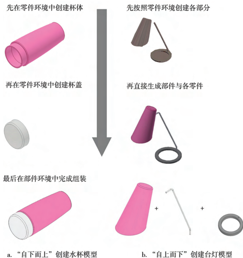
图 1.19 水杯与台灯模型的建立过程
